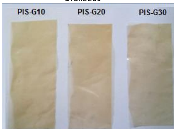
Figura 19 – Fotografia dos filmes obtidos com PIS e os diferentes teores de glicerol avaliados
