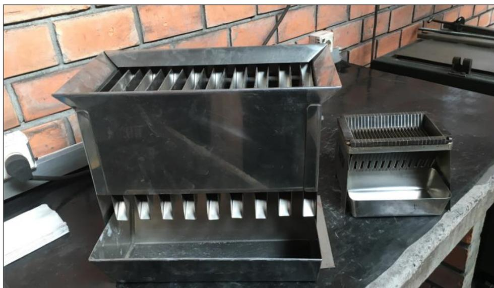
Figura 7: Quarteador tipo Jones utilizado para fracionamento das amostras
