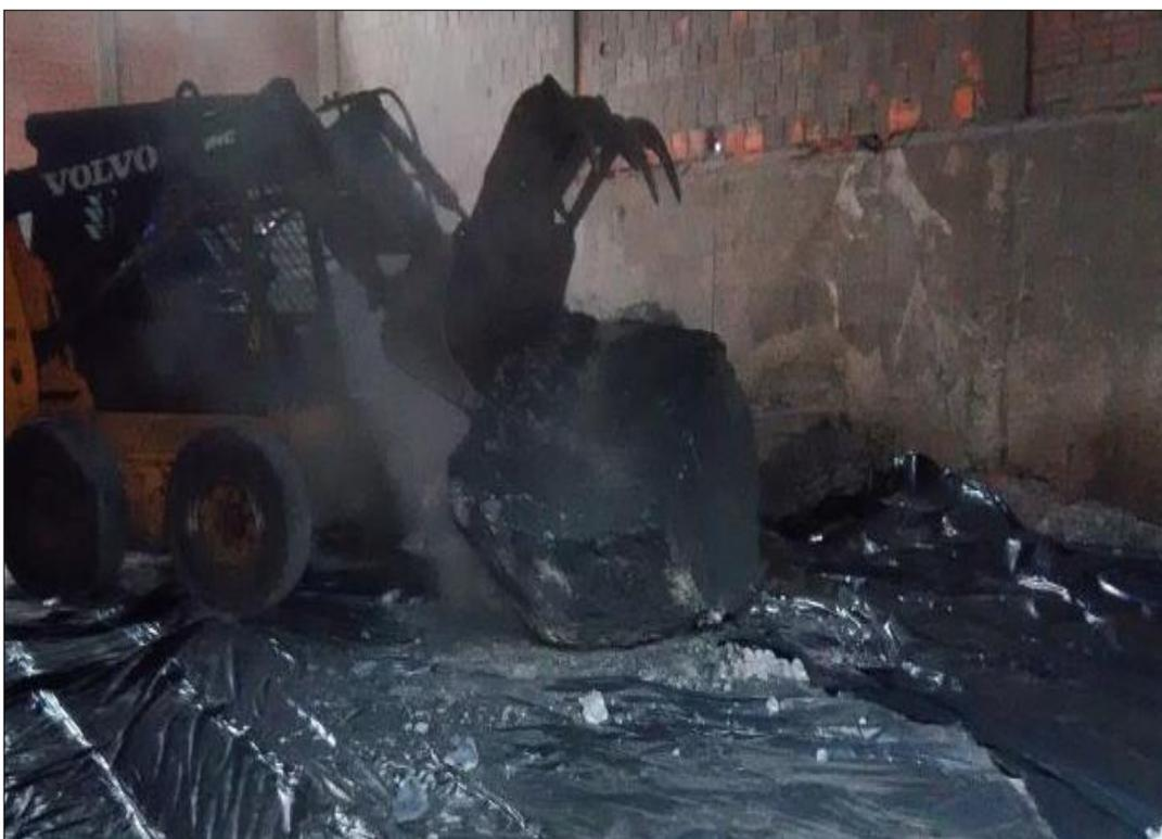
Figura 1: Bloco de escória salina obtido após resfriamento.
