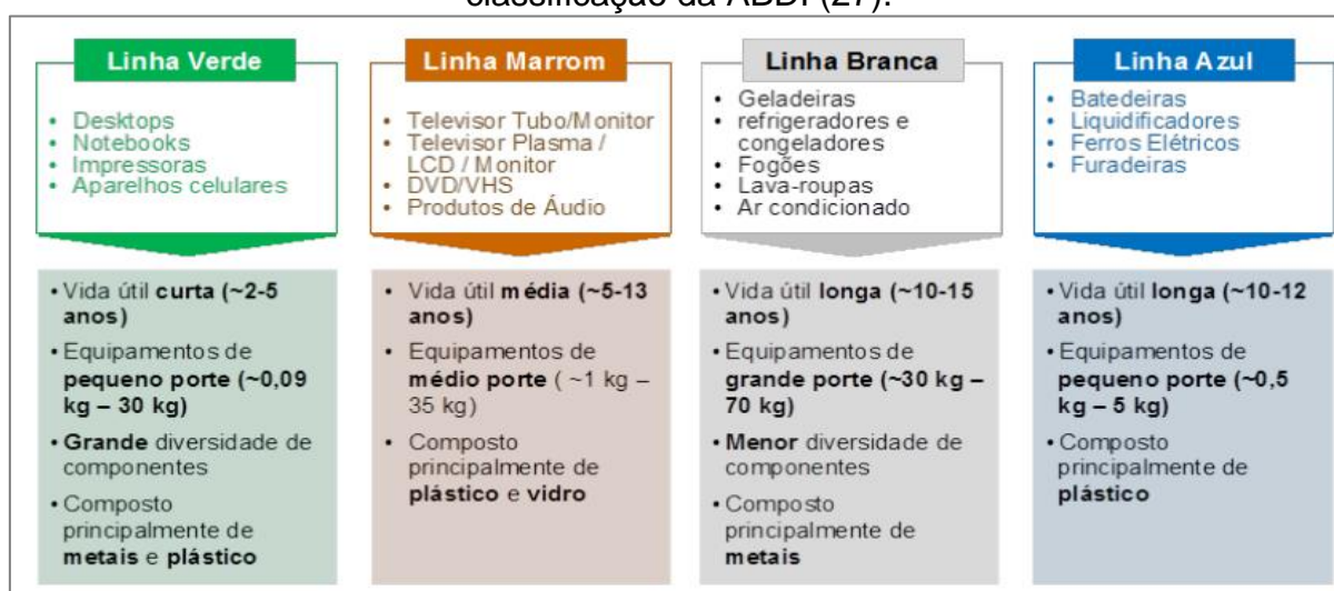
Figura 2 - Categorias dos equipamentos eletroeletrônicos no Brasil de acordo com a classificação da ABDI (27).
