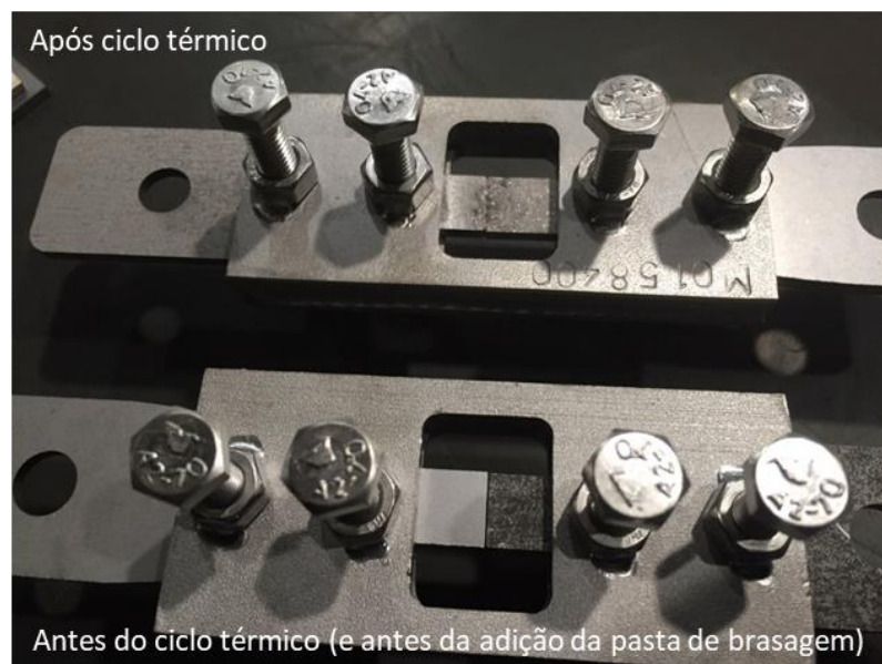
Figura 14: Conjunto montado para execução das brasagens.
