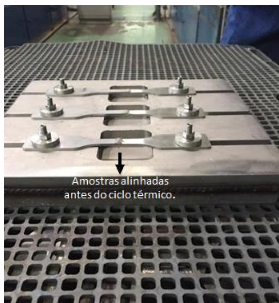
Figura 10: Suporte da Figura 9 sendo utilizado para primeiros testes de brasagem.
