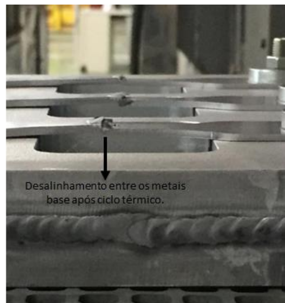
Figura 10: Suporte da Figura 9 sendo utilizado para primeiros testes de brasagem.
