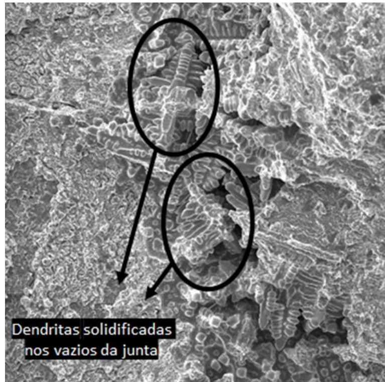
Figura 36: Aumento da Figura 32 com indicativo da solidificação dendrítica
