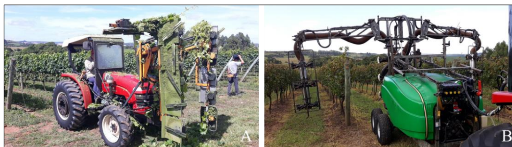
Figura 19: Equipamento utilizado para realização do desponte das plantas (A); pulverizador de múltiplas filas utilizado em tratamentos fitossanitários (B). Fonte: Leonardo Pereira Fortes, Vinhedo Chandon Encruzilhada do Sul, 2019.
