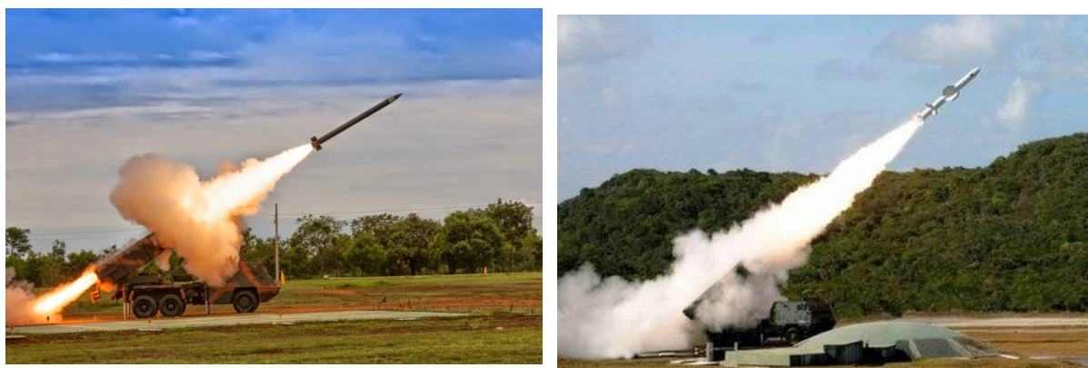
Figura 5: Foguete Guiado AV-SS 40 G e míssil MTC AV 300 lançados da plataforma ASTROS
