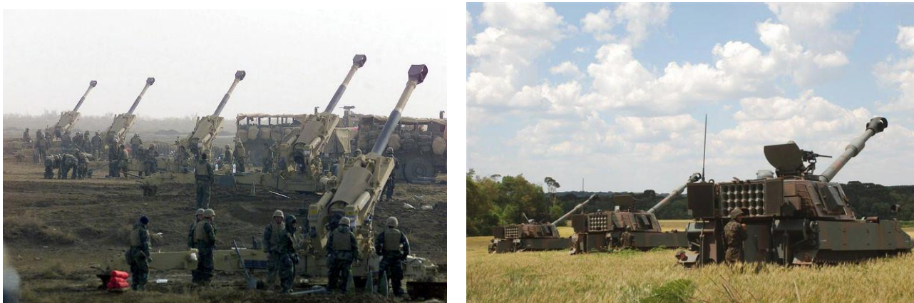
Figura 10 – Bateria de obuses (à esquerda obus M998 – EUA e à direita M109A3 - Brasil)
