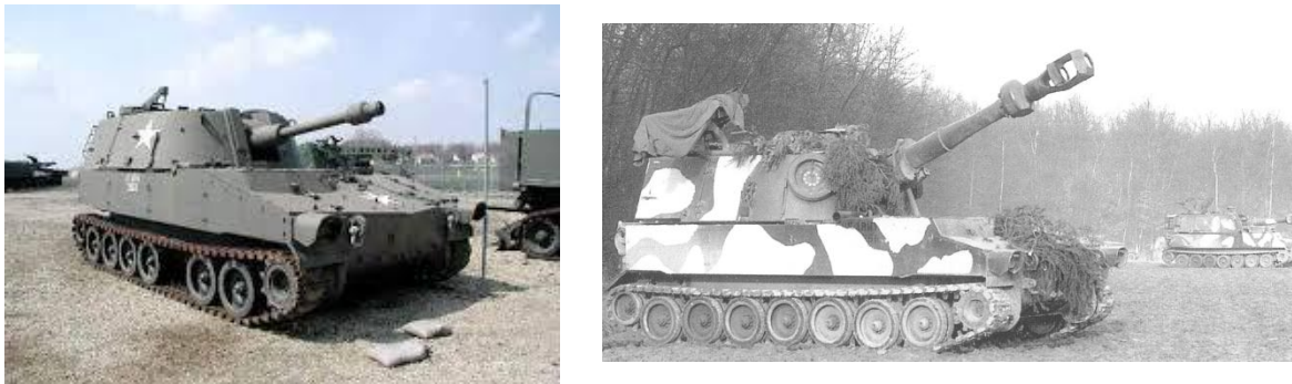
Figura 14 – Obuseiro M108 105mm (à esquerda) e Obuseiro M109 155mm (à direita)
