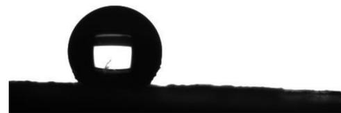
Figura 5- Foto produzida pelo aparelho WCA do teste de ângulo de contato da rota ácida branco com C8 (ângulo de aprox.  $137,1^\circ$ ).
