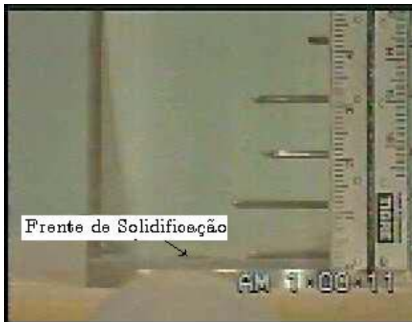
Fig. 4.14 Início do processo de solidificação com pequena camada já solidificada
