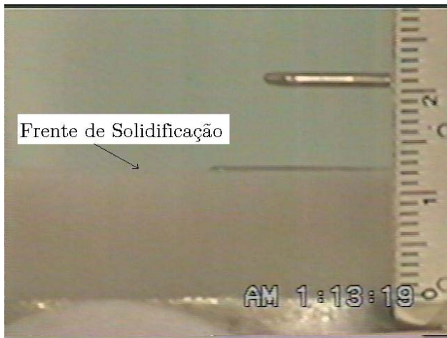
Fig. 4.18 Detalhe da frente de solidificação no 2° termopar
