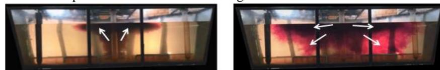
Figura 3 – Linhas de fluxo no interior do distribuidor
