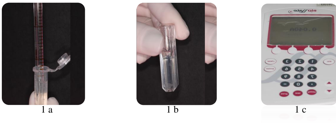
Figura 1 a: Remoção de 1ml da solução na qual o dente estava imerso. b: Reação do tipo oxidação-redução. c: leitura em espectrofotômetro.
