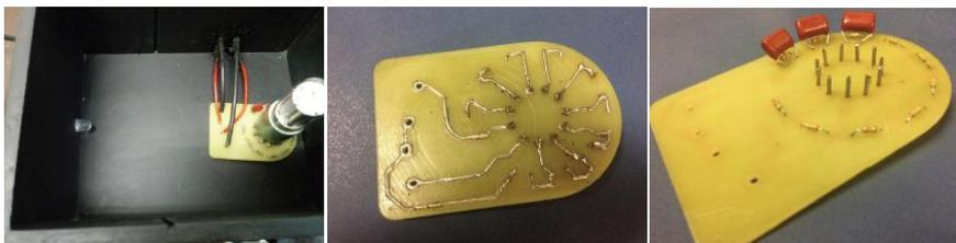
Figura 1: Abrigo e placa de circuito impresso para a PMT.
