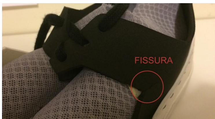
Figura 61: Fissura ocasionada pela torção da estrutura, visível no ponto de amarração dos atacadores.
