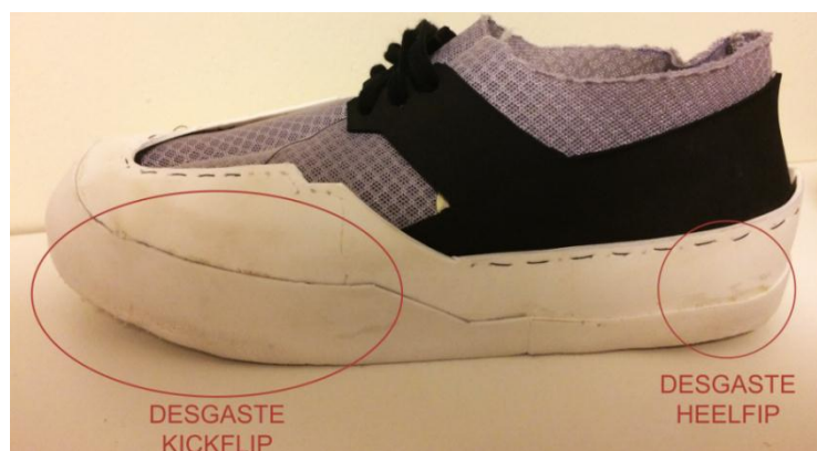
Figura 64: Regiões que sofreram desgaste durante realização das manobras anteriores.
