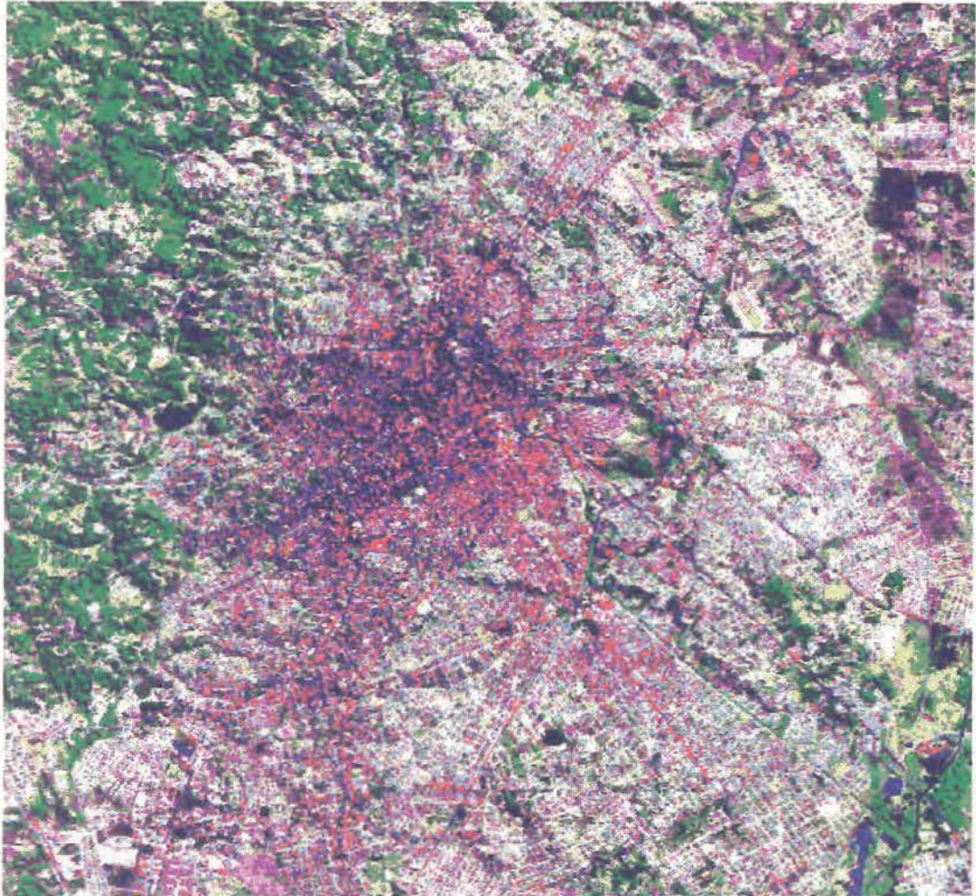
Figura 5.9 - Curitiba-PR, composição colorida com Landsat TM345 Cores verdes, vermelhos e azuis correspondem a vegetação, malha urbana e superfícies de água, respectivamente.
