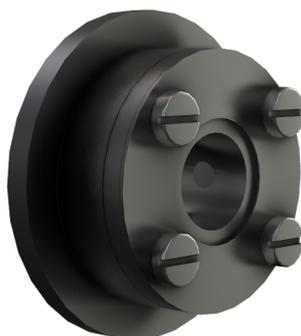
A principal funcionalidade da peça é o fato dela possuir um pequeno poço de aproximadamente 250  $\mu\text{L}$  de volume, em pressão atmosférica, que possibilita a análise de líquidos e amostras vivas. O mecanismo foi cunhado de feixe externo-interno aqui no laboratório. A proposta das irradiações é justamente fazer uso desse poço para que as células possam ser irradiadas estando embebidas em seu meio de cultura, a fim de minimizar os estresses provenientes do ambiente externo.
