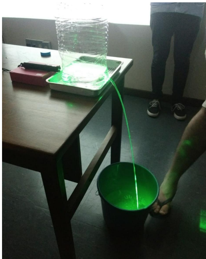
Figura 4.7: Experimento sobre reflexão total realizado em uma apresentação de prática de regência na UFRGS dia 13 de Novembro de 2019.
