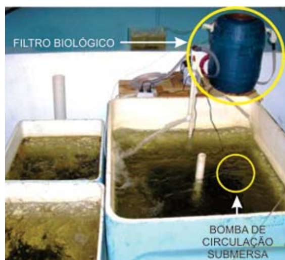
Figura 1. Sistema de tanques para manutenção de mexilhões em laboratório (Características: 500 Litros; 24-26°C; pH: 6,5-7,5; Oxigênio saturado por aeração constante; Circulação de água constante; Filtração em sistema de filtro biológico e substituição semanal de um terço do volume dos tanques) (Campos, 2009).
