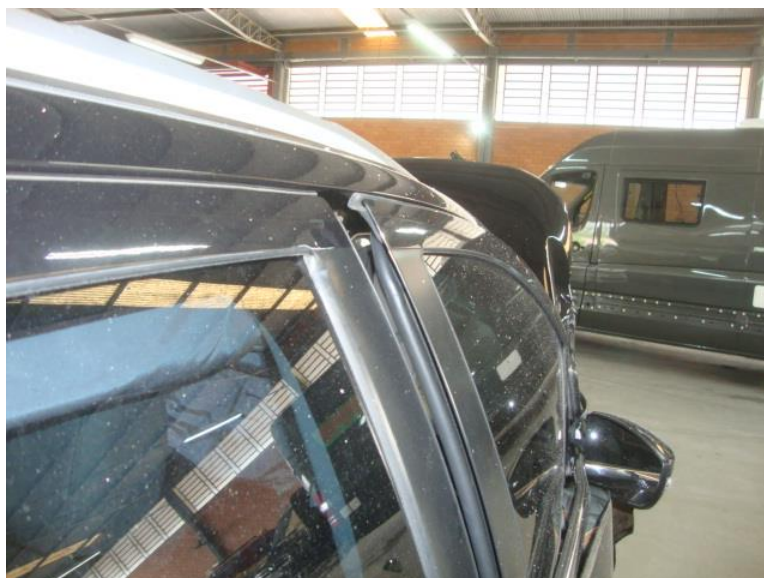
Figura A.5 – Desalinhamento de porta, flecha de deformação.
