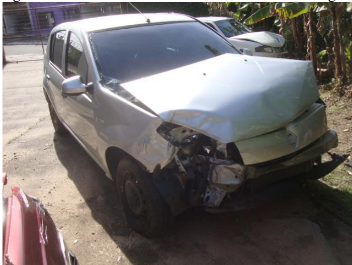
Figura A.8 – Colisão com características sem frenagem.
