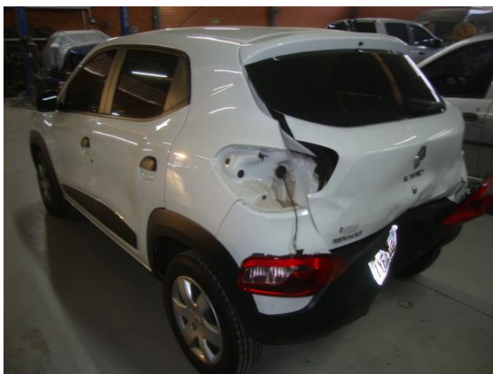
Figura A.8 – Colisão com características sem frenagem.
