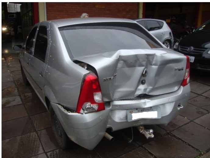
FiguraA.7 – Características de deformação com frenagem.
