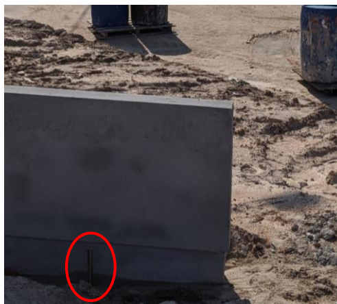
Figura 19 - Materialização do primeiro vértice Fonte: as autoras
