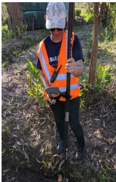
Figura 21 - Medição das coordenadas do marco geodésico Fonte: as autoras
