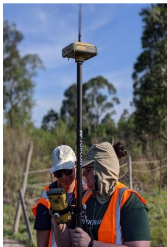
Figura 22 - Medição de coordenadas dos pontos três, quatro e cinco. Fonte: as autoras
