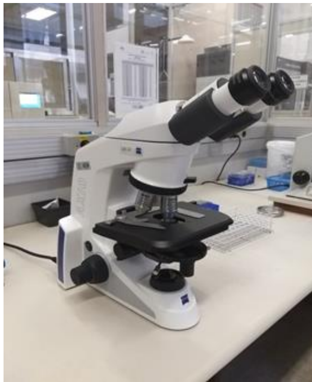
Figura 1: microscópio óptico (ZEISS AXIO LAB A1) utilizado em rotina laboratorial apresentando microscopia em campo claro, contraste de fase, luz polarizada e campo escuro.
