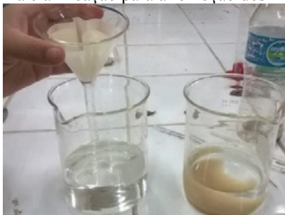
Figura 4: Filtração do sistema clarificação para a remoção dos flocos sedimentados.
