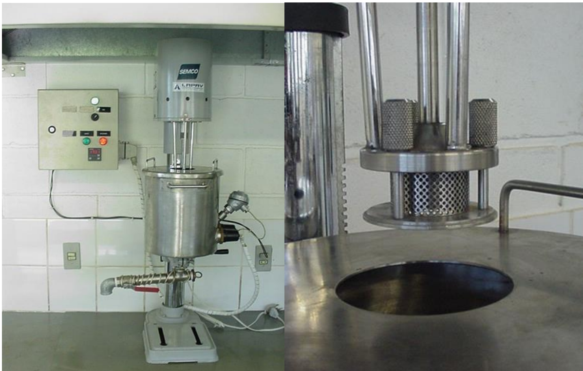
Figura 5: Reator utilizado para modificação do CAP e em detalhe o cabeçote cisalhante.
