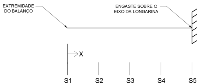
Figura 19 - Seções para o cálculo dos momentos devidos à carga permanente no balanço
