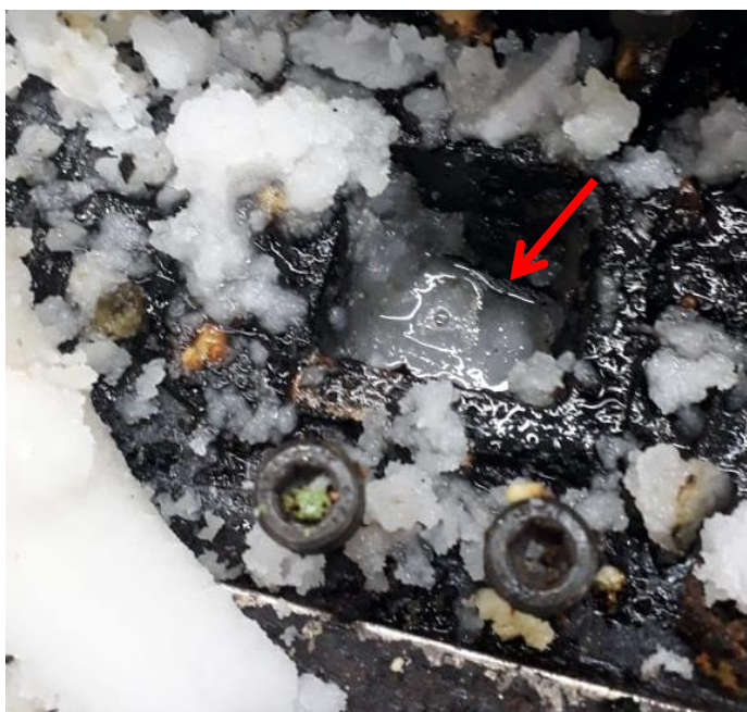
Figura 13 – Separação do plastificante polimérico durante a extrusão na concentração de 60pcr.
