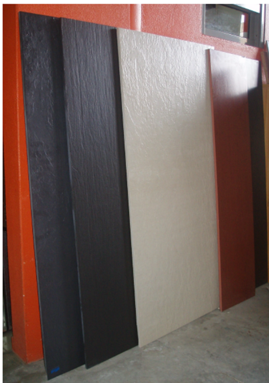
Figura 4: Placas de revestimento de Grés Porcelanato.
