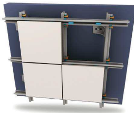
Figura 22: Subestrutura de fixação contínua em aço inoxidável.
