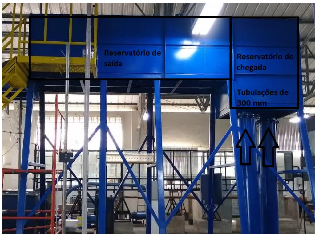
Figura 26 – Disposição dos reservatórios de estabilização no modelo
