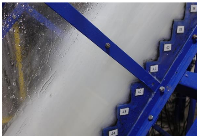
Figura 43 – Demonstração da região de escoamento uniforme para vazão de 150 l/s
