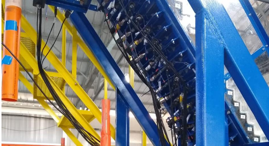
Figura 37 – Disposição dos transdutores na calha do vertedouro
