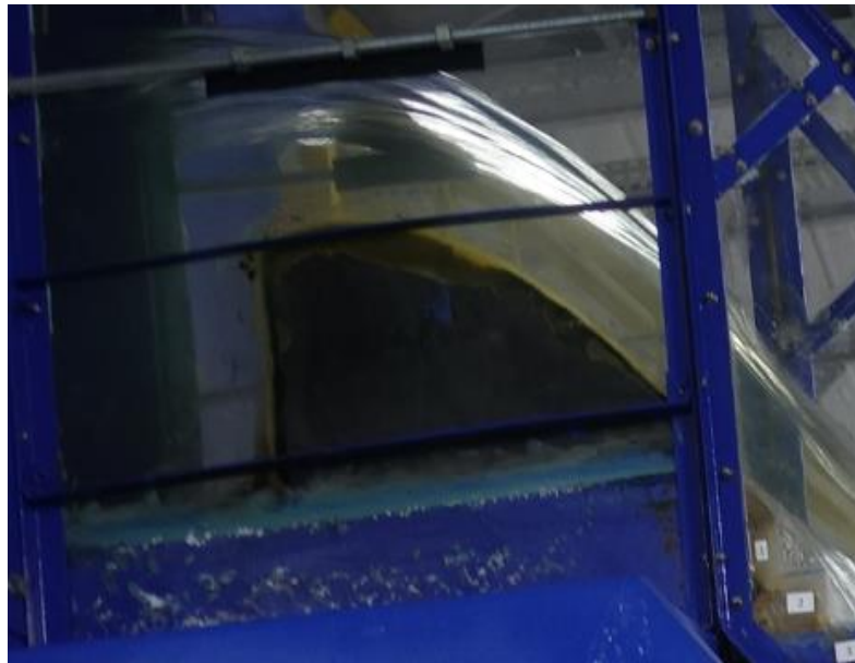
Figura 39 - Escoamento sobre ogiva para vasão de 150 l/s.
