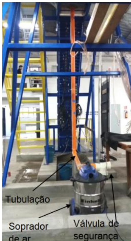
Figura 34 - Sistema soprador de ar
