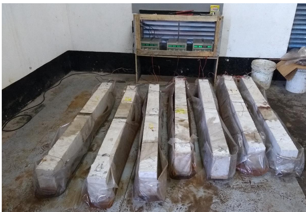
Figura 28 - Piscinas de corrosão.
