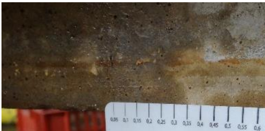
Figura 57 - Medição da abertura de fissura da viga V04COFA.
