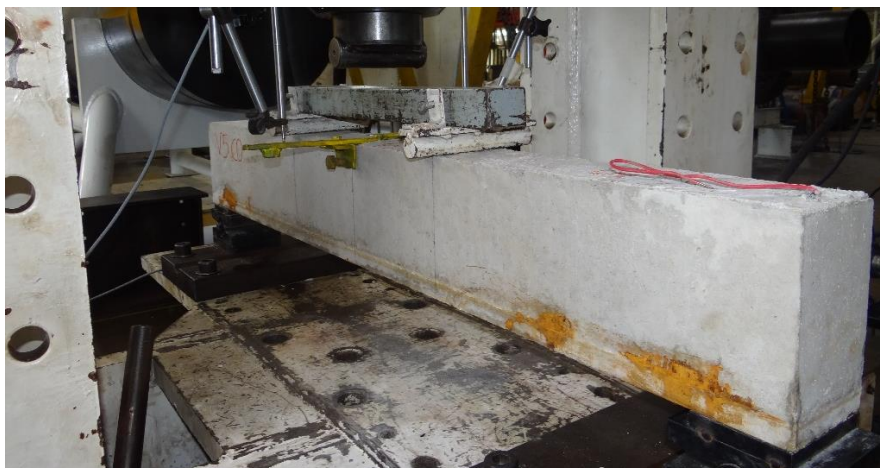
Figura 55 - Viga V05CO antes da aplicação dos carregamentos cíclicos.
