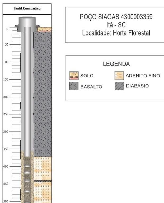
Figura 30 - Perfil construtivo de poço que capta água do SASG. Elaborado pela autora com base em SIAGAS/CPRM.
