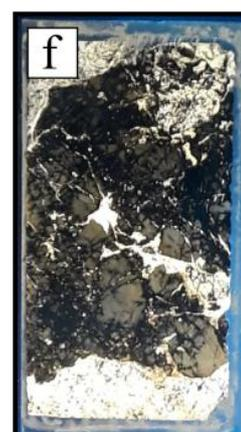
Figura 12:: Amostras 1-270 em (a), 1-271 (c) e 1-274 (e) do testemunho de sondagem BRSMSMDD0186 da área 1 do depósito Santa Maria, o retângulo amarelo representa a área que foi laminada. As fotos (b), (d) e (f) são as laminas delgadas sob luz polarizada das amostras 1-270, 1-271 e 1-274, respectivamente.
