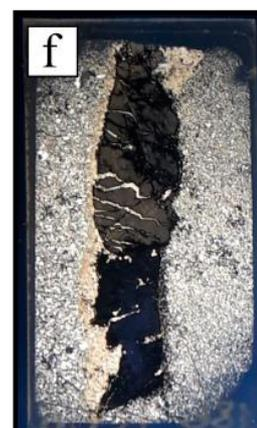
Figura 11: Fotos das amostras 1-119 em (a), 1-139 em (c) e 1-177 em (e) do testemunho de sondagem BRSMDD0186 da área 1 do depósito Santa Maria, o retângulo amarelo representa a área que foi laminada. As fotos (b), (d), (f) e são as lâminas delgadas sob luz polarizada das amostras 1-119, 1-139 e 1-177, respectivamente.
