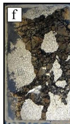
Figura 13: Amostra 2-187 em (a) do testemunho de sondagem BRSMSMDD0031 da área 2 do depósito Santa Maria. Amostras 3-140 e 3-141 do testemunho de sondagem BRSMSMDD0096 da área 3 do depósito Santa Maria. Os retângulos amarelos representam as áreas que foram laminada. As fotos (b), (d) e (f) são as laminas delgadas sob luz polarizada das amostras 2-187, 3-140 e 3-141, respectivamente.
