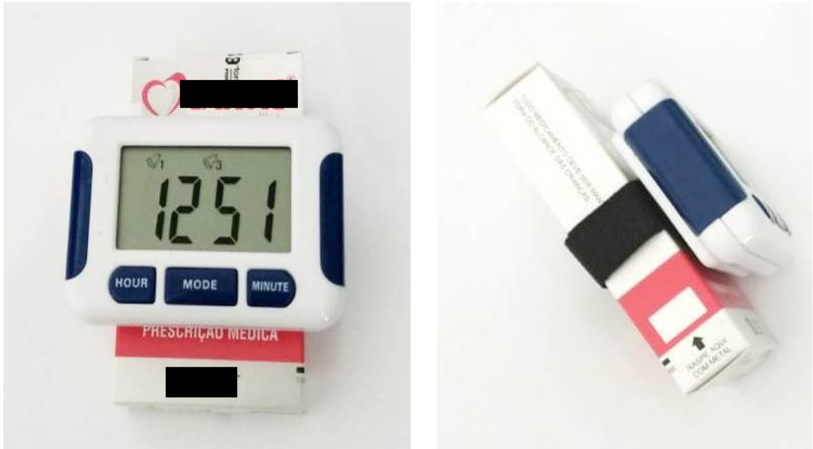
Figura 5 – Ilustração do dispositivo finalizado acoplado à caixa do medicamento.
