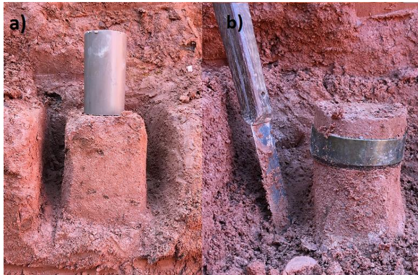
Figura 18 – (a) Retirada de bloco indeformado para ensaios triaxiais; (b) Retirada de amostra indeformada em anel de cisalhamento direto.
