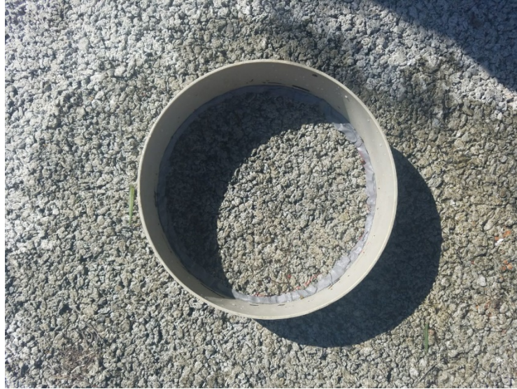
Figura 8 – Ensaio de infiltração em pavimento de concreto permeável – exemplo realizado em vaga de estacionamento no Campus do Vale da Universidade Federal do Rio Grande do Sul pelo Laboratório de Ensaios e Modelos Estruturais – LEME (AUTORA, 2018).
