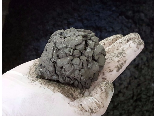
Figura 22 – Consistência da mistura de concreto permeável.
