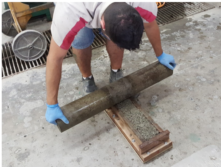
Figura 33 – Compactação com o uso do rolo em corpos de prova prismáticos.
