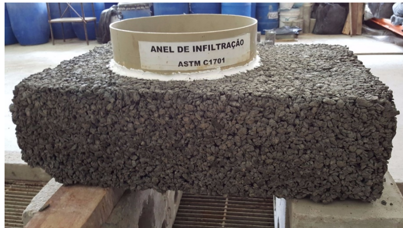
Figura 15 – Teste de infiltração em placa de concreto permeável.
