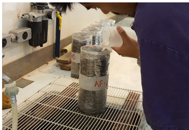
Figura 16 – Teste de infiltração em corpos de prova cilíndricos de concreto permeável.
