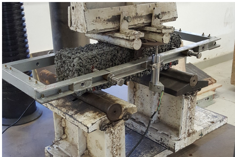
Figura 18 – Uso de LVDT para medição da flecha de viga no ensaio de tração na flexão.
