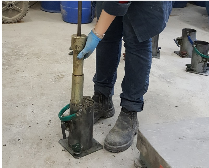
Figura 20 – Compactação de corpo de prova cilíndricos com o uso do Proctor.
