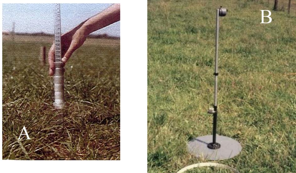
FIGURA 9. A) Foto de um “Sward stick”, usado para as determinações da altura da pastagem. B) Foto de um disco medidor de forragem para determinações de massa de forragem e alocações de gaiolas
