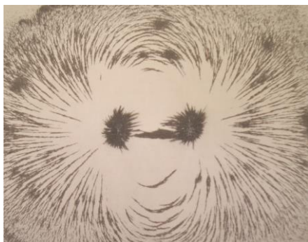
Figura 1.2: Nos polos de um ímã existe maior concentração de limalhas de ferro porque o campo magnético é mais intenso.
