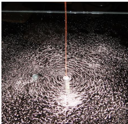
Figura 2.3: A fotografia mostra a disposição das limalhas de ferro ao redor de um fio retilíneo percorrido por corrente elétrica. Consideramos que a configuração das limalhas forma linhas de campo magnético circulares ao redor do fio.
