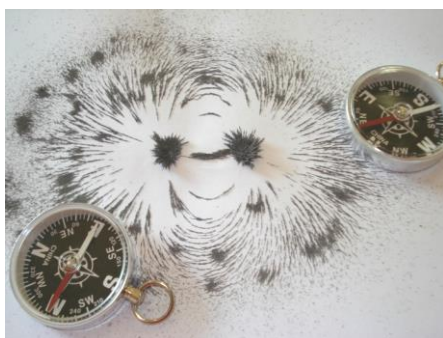
Figura 1.11: A distribuição das limalhas de ferro e a orientação da agulha magnética das bússolas evidenciam seus alinhamentos com a direção do campo magnético.
