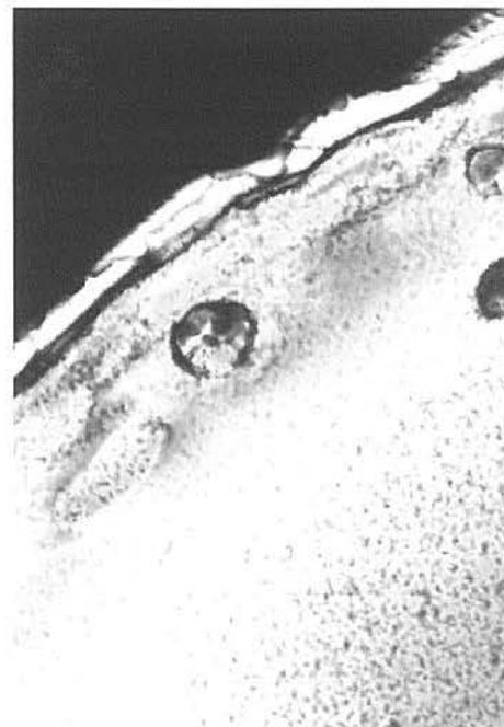
Foto 8: Textura nemática da amostra P_{4Cl} a 54^{\circ}C no resfriamento (66x).
