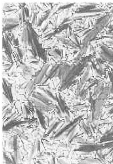
Foto 2: Textura focal cônica da fase esmética A do P_{11M} no resfriamento a 30 °C (125x; 5 °Cmin -1 ).
