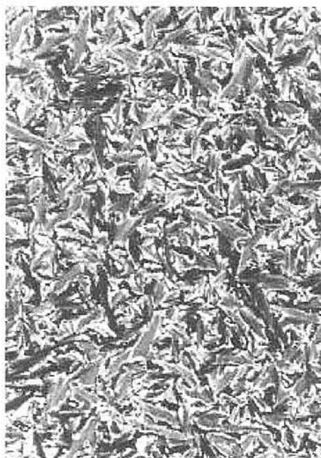
Foto 3: Textura focal cônica da fase esmética A do P_{11M} no resfriamento a 98 °C (66x; 5 °Cmin -1 ).
