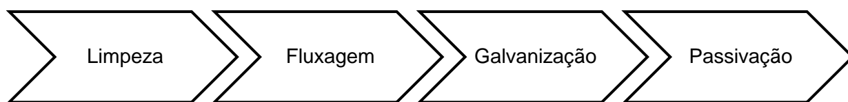
Figura 3. Etapas do processo de galvanização por imersão a quente (20).
