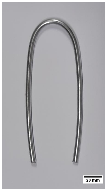
Figura 12. Exemplo de corpo de prova de arame galvanizado de 30 cm de comprimento.
