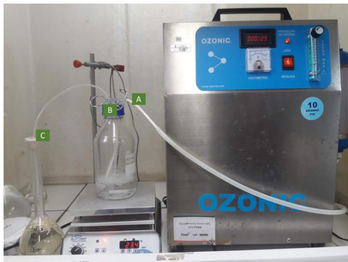
Figura 6. Arranjo do tratamento por ozonização: A) Entrada do ozônio, B) Retirada da amostra, C) Tratamento do gás efluente em solução de KI
