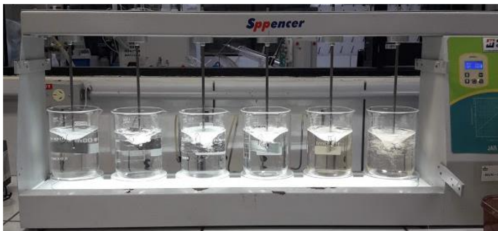
Figura 5. Teste de jarro realizado na Amostra B (solução de nonilfenol etoxilado) em duplicatas com três coagulantes diferentes, da esquerda para direita: Sulfato de alumínio, policloreto de alumínio e tanino vegetal.
