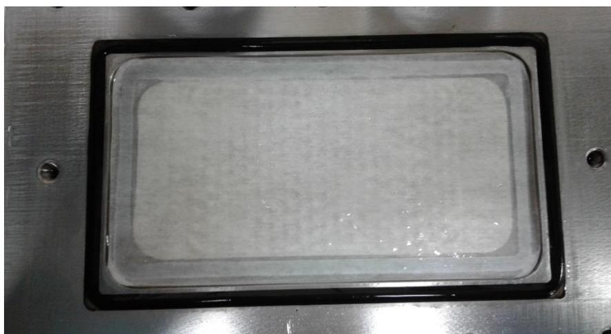
**Figura 9.** Imagem da membrana disposta no módulo utilizado em um dos experimentos.
