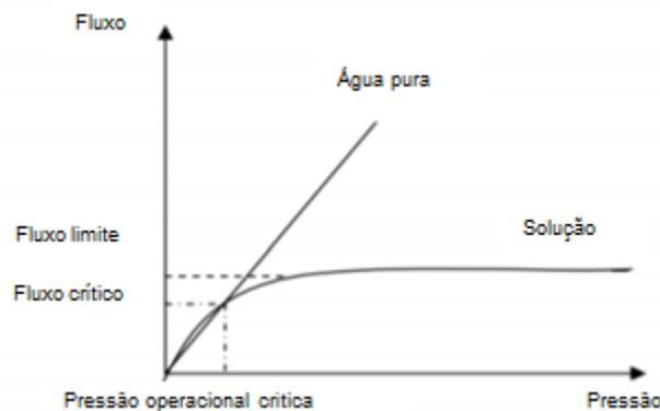
**Figura 5.** Representação da curva de fluxo limite e fluxo crítico.
