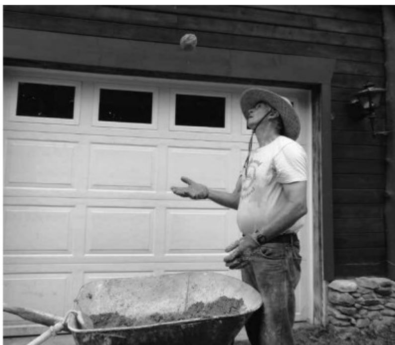
Figura 23: A bola de argamassa não se fragmenta quando arremessada ao ar (ROY, 2018, p.57).
