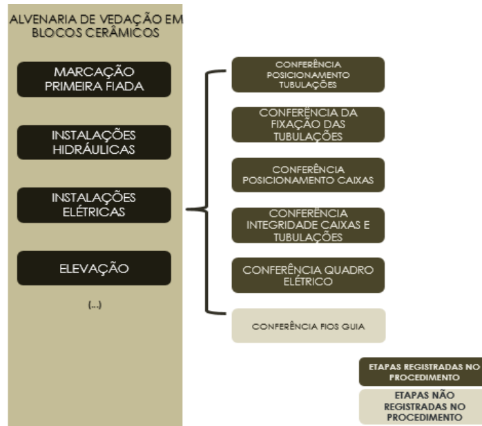
Figura 46– Mapeamento dos processos: comparativo procedimento
