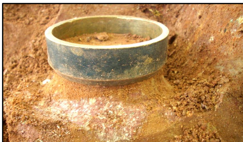
Figura 7-3 – Etapa de moldagem de corpo de prova de solo residual
