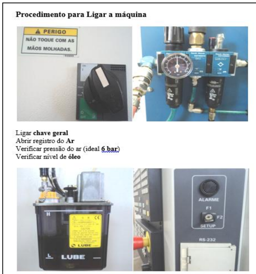
Figura 9: Procedimento para ligar a máquina
