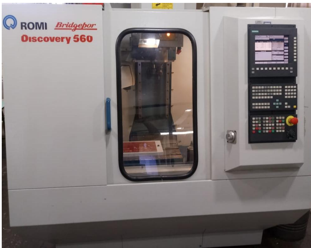
Figura 1: Centro de usinagem CNC modelo ROMI-Discovery 560
