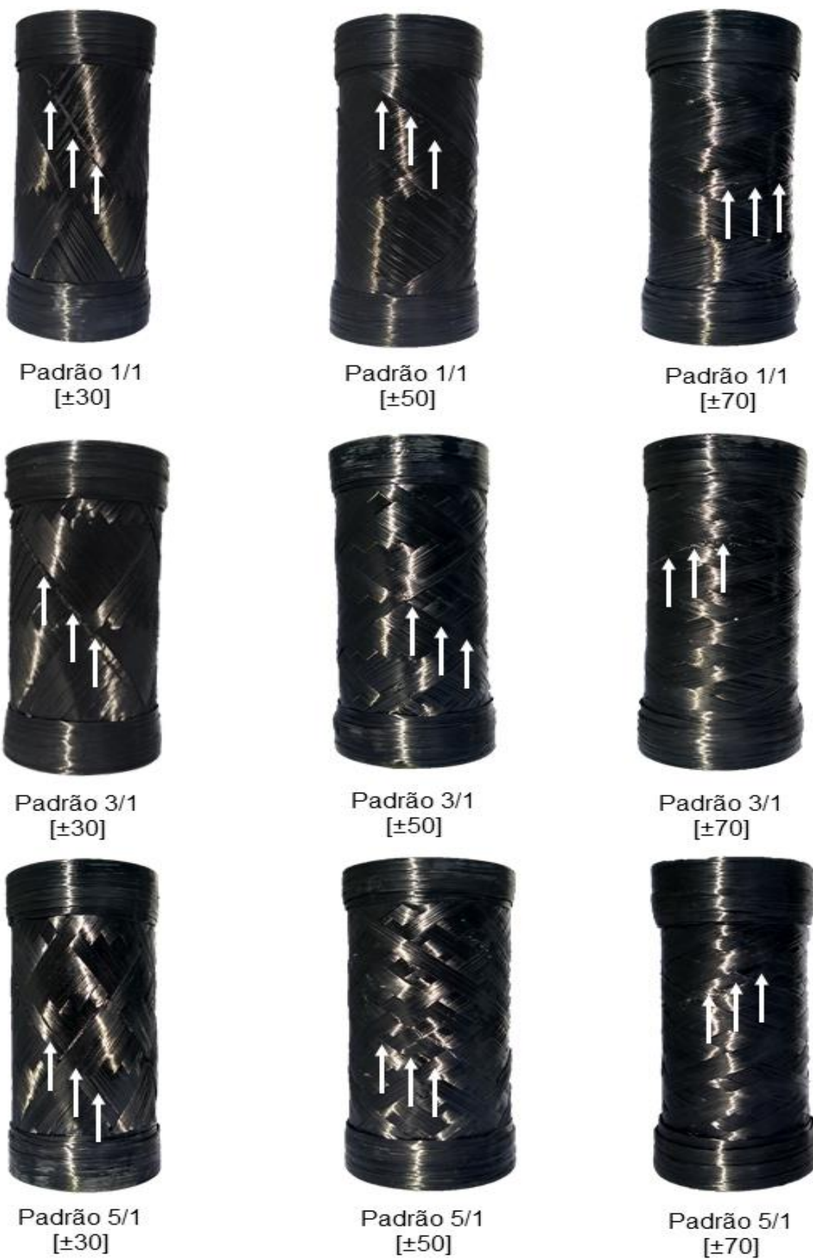
Figura 31. Fotografias dos cilindros fraturados.
