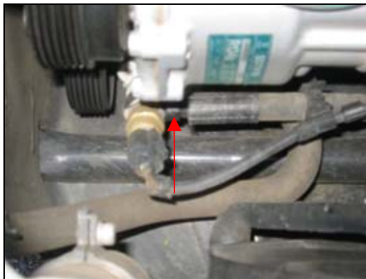
Figura 3.1 - Posicionamento do acelerômetro na bomba do Golf.
