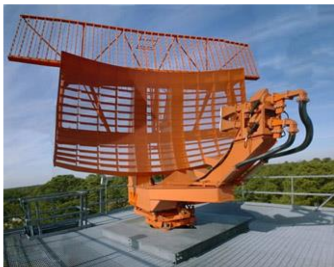
Figura 1 - Radar primário e Secundário atuado em conjunto
