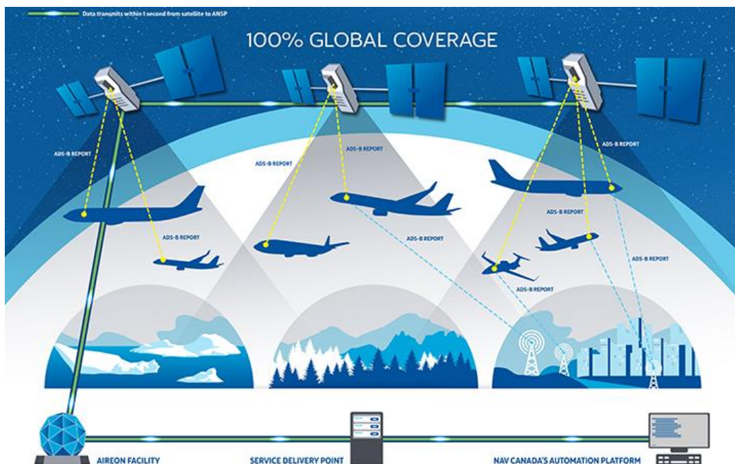
Figura 19 - ADS-B com recepção por satélite
