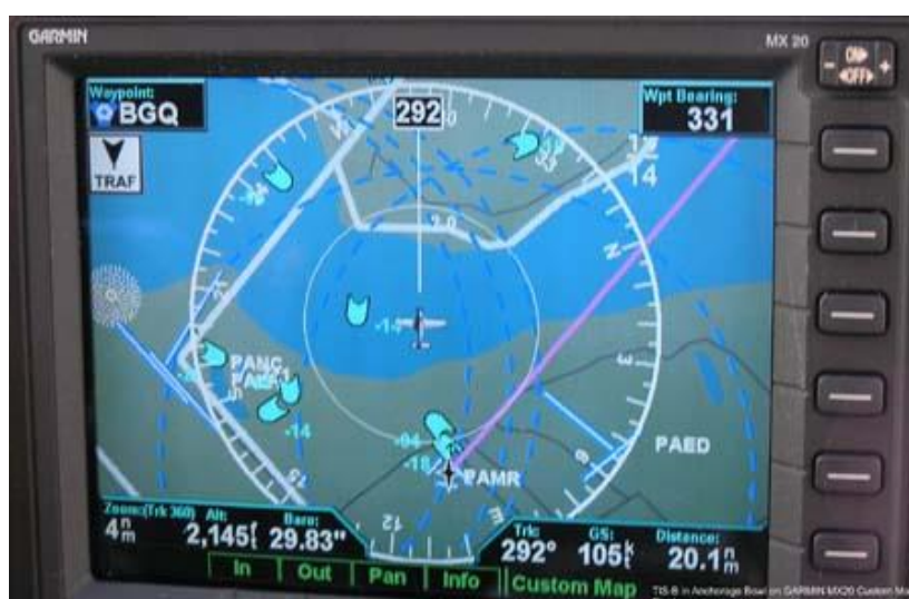
Figura 9 - TIS-B em um avião com ADS-B
