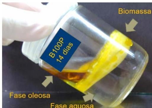
**Figura 2:** Aspecto do frasco aos 14 dias de experimento mostrando a formação de biomassa de aspecto membranoso separando a fase aquosa da fase oleosa.
