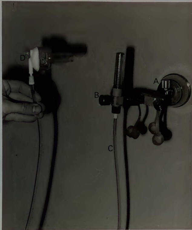
FIGURA 1: Sistema de nebulização. A: Válvula para ar comprimido; B: fluxômetro; C: tubo de látex; D: Nebulímetro.
