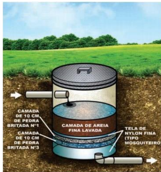
Figura 5 – Filtro na caixa coletora de efluente
