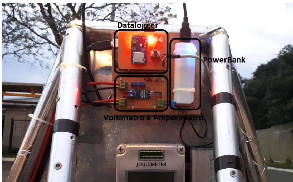
Figura 19 – Instalação dos instrumentos no veículo.
