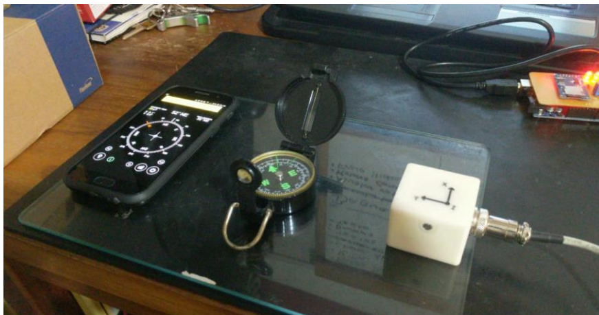
Figura 14 – Calibração da IMU.
