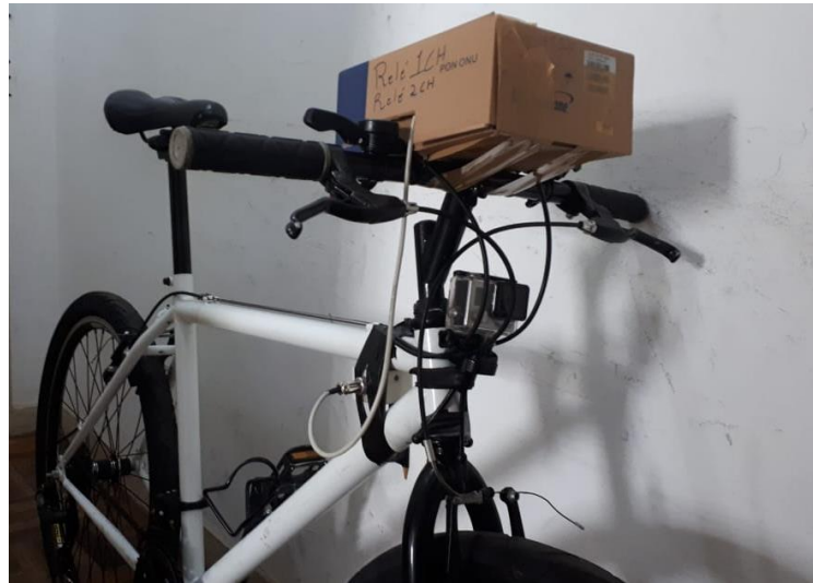
Figura 21 – Ensaio de offset para ângulo de roll na bicicleta.
