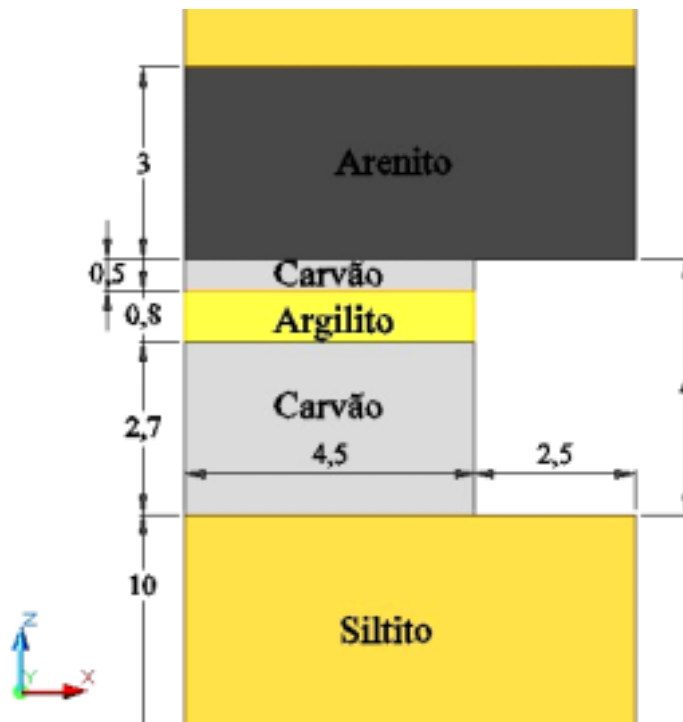
Figura 4.15 – Detalhe das dimensões do modelo na camada de carvão, incluindo a geologia.
