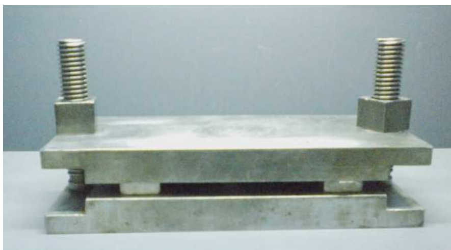
Figura 29: Dispositivo de compressão à deformação constante
